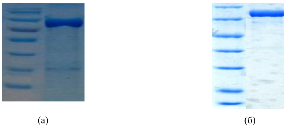
Рисунок 1 – Электрофорез выделенных препаратов С-His-Lon-протеазы –(а) и ее мутантной формы Lon-S679A - (б). (ПААГ, SDS, 1 - белки-маркеры, 2 - целевые белки).
